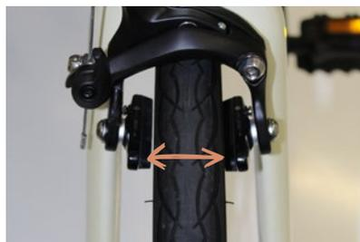
Nel momento in cui la ruota è montata, spingere il bloccaggio dei freni verso il basso. Questi speciali bloccaggi a sgancio rapido hanno lo scopo di aiutare nel montaggio e nello smontaggio della ruota anteriore.
