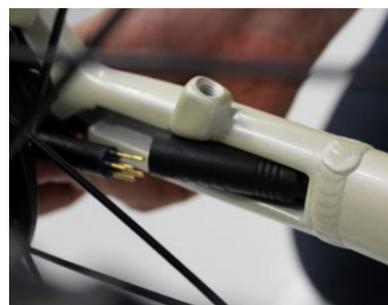
Questo connettore è integrato nel foderò. Il connettore è impermeabile e normalmente ben fissato, è per questo necessaria un po' di forza per aprirlo e chiuderlo. È importante che la spina del motore sia scollegata prima che la ruota posteriore venga rimossa. Smontare la ruota richiede a questo punto le stesse operazioni come per una bicicletta convenzionale.
